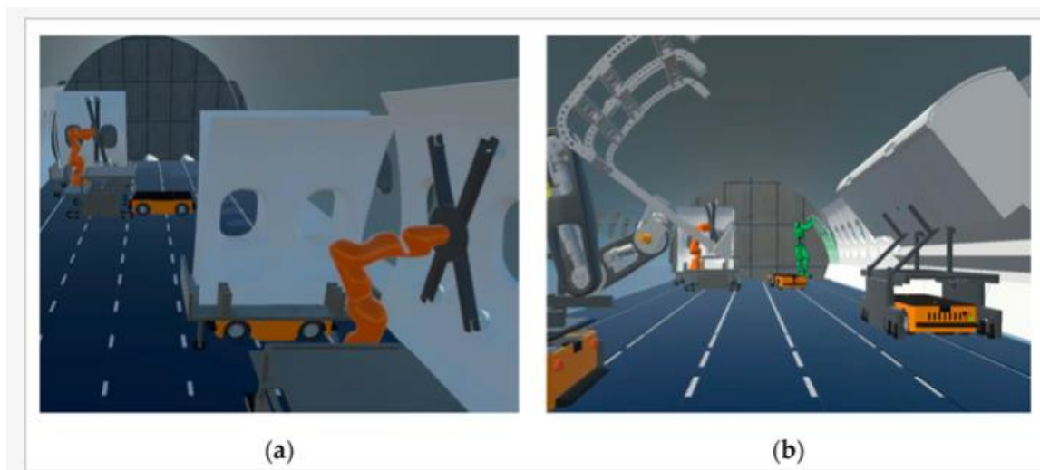
Rys. 38. Symulacja końcowej linii montażowej samolotu. a) ramiona robotów umieszczających panele ścian bocznych, b) HRC (ang. Human–Robot Collaboration) na przykładzie człowieka i ramienia robota umieszczającego panele ścian bocznych [96].
