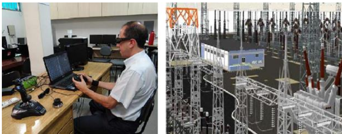
Rys. 37. Prezentacja projektu VRCEMIG - poruszanie się po wirtualnej podstacji elektrycznej [95].
